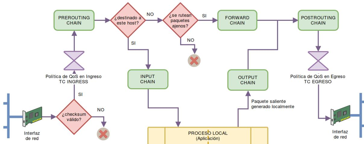
Figura 1: Esquema de funcionamiento de las interfaces de red de un equipo linux
