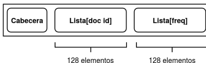
Figura 3.7: Estructura de un bloque Block-Max
