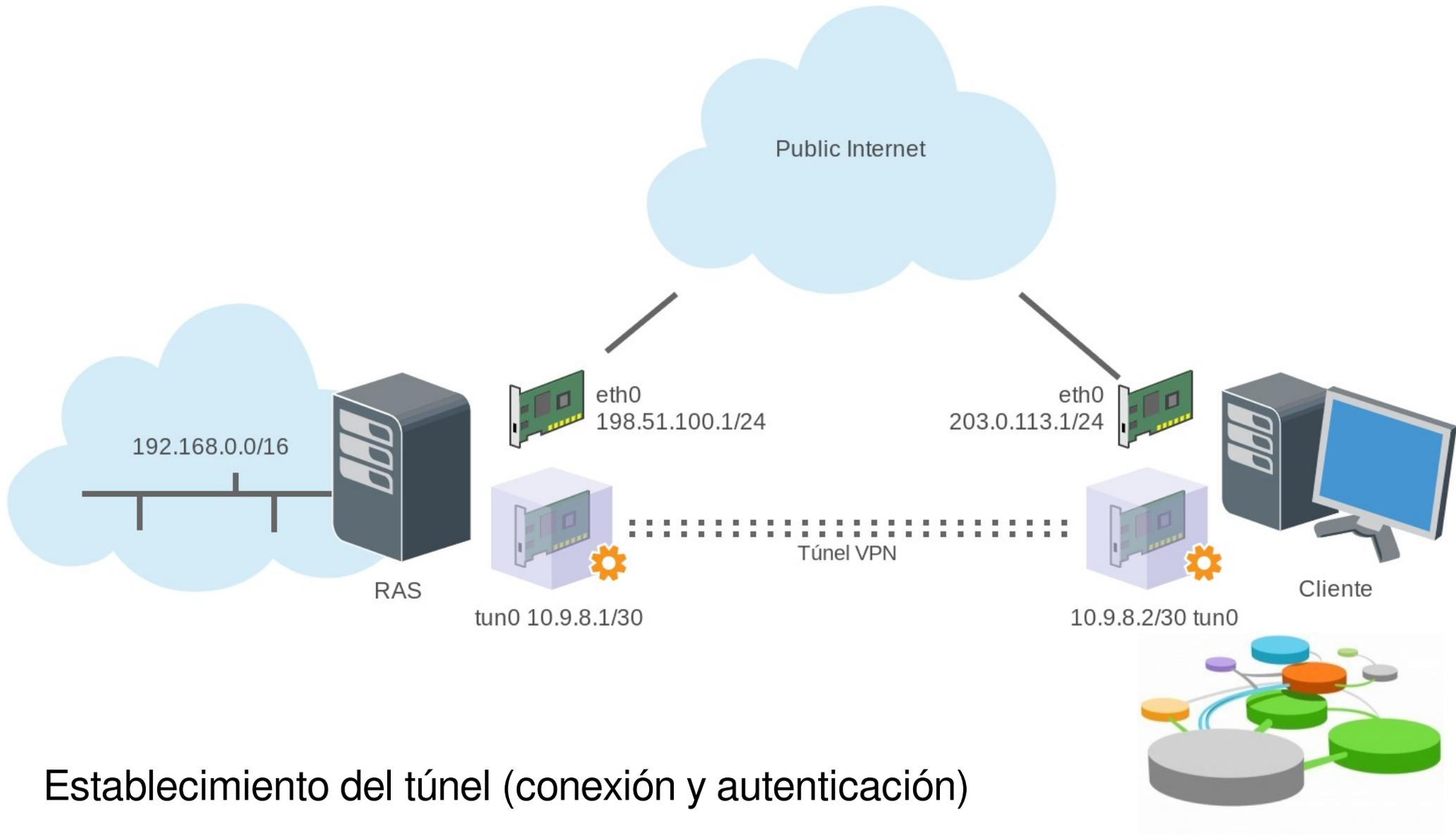
Establecimiento del túnel (conexión y autenticación)
