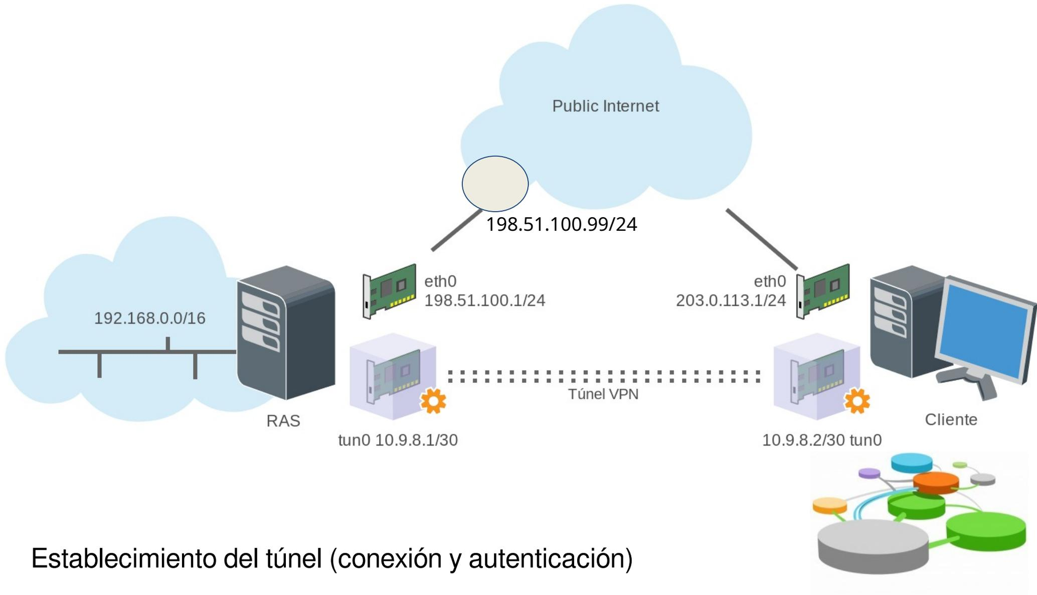
Establecimiento del túnel (conexión y autenticación)
